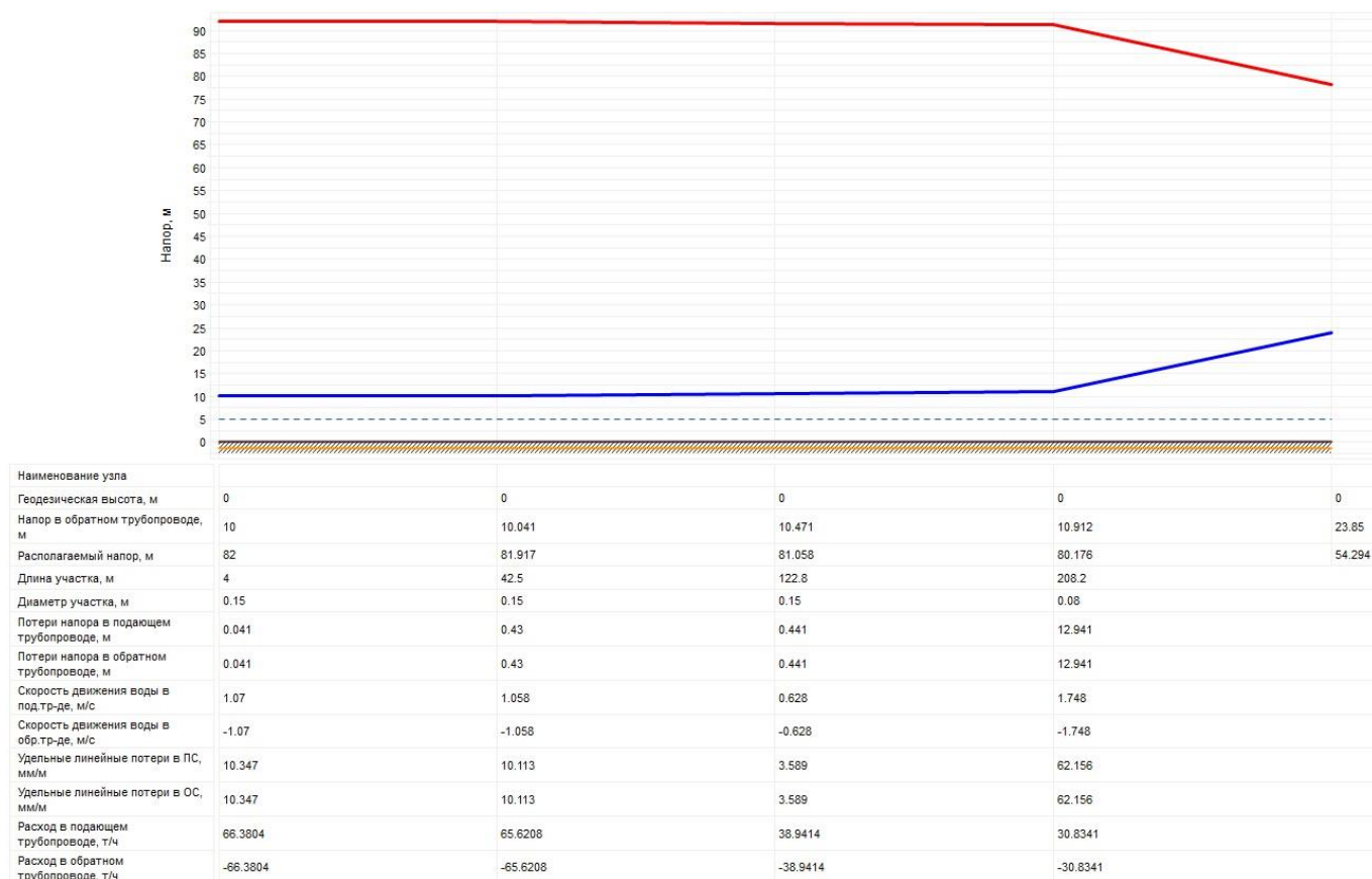
Рисунок 2.60 – Пьезометрический график от источника теплоснабжения (Котельной №1 с. Глядянское) до самого удаленного потребителя
