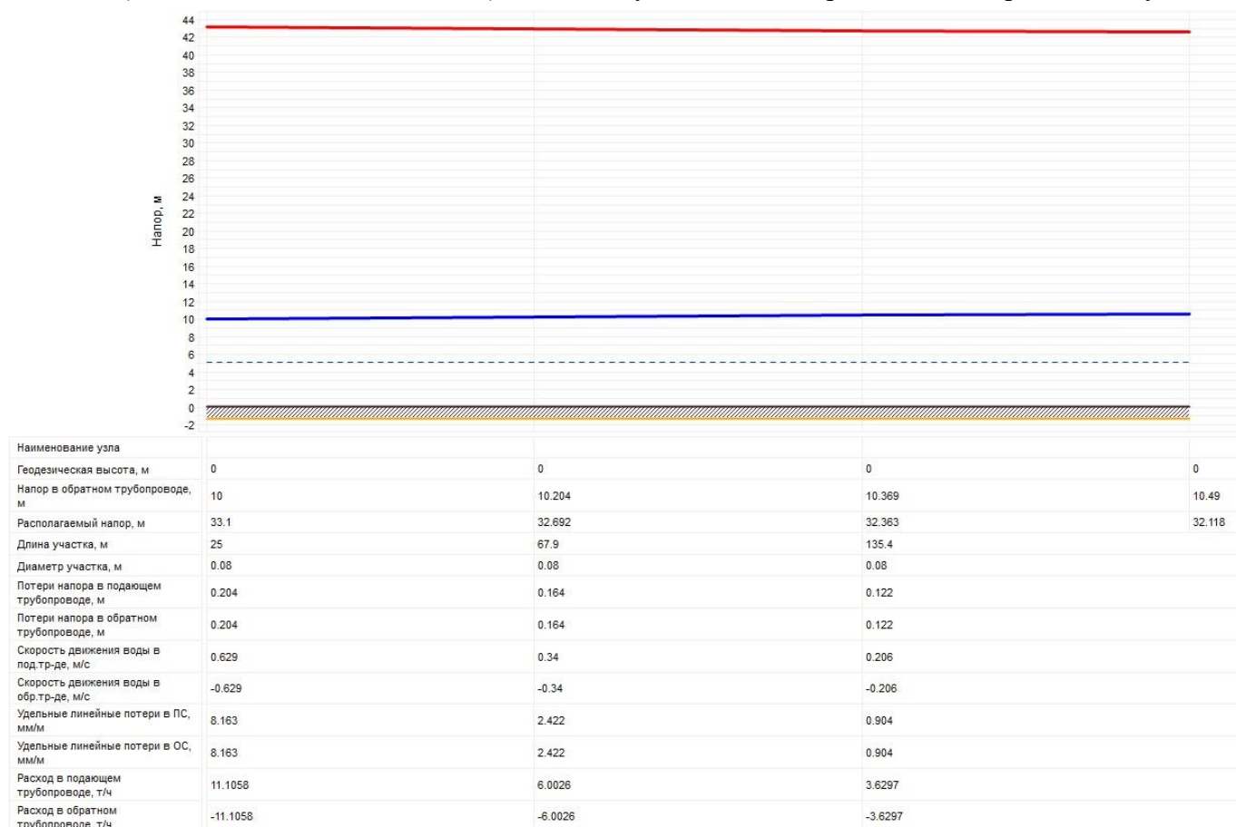
Рисунок 2.74 – Пьезометрический график от Котельной №2 с. Глядянское до самого удаленного потребителя в аварийной ситуации
