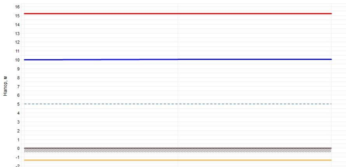
Рисунок 2.19 – Пьезометрический график тепловой сети Котельная с. Нагорское
