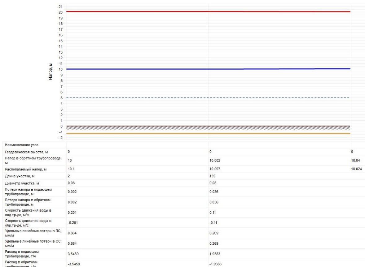
Рисунок 2.83 – Пьезометрический график от Котельной с. Плотниково до самого удаленного потребителя в аварийной ситуации
