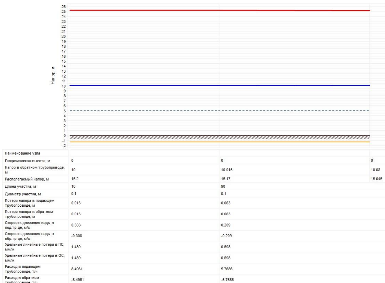
Рисунок 2.33 – Пьезометрический график тепловой сети Котельная с. Гладковское
