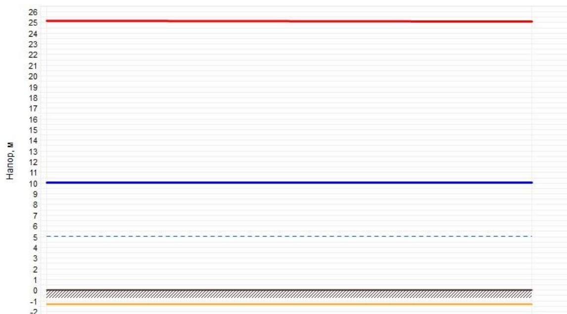
Рисунок 2.13 – Пьезометрический график тепловой сети Котельная с. Боровлянка
