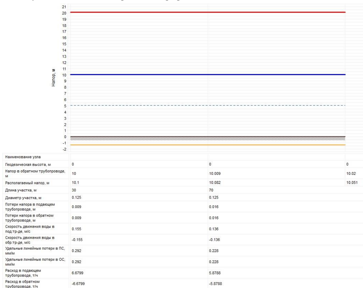
Рисунок 2.36 – Пьезометрический график тепловой сети Котельная с. Ялым
