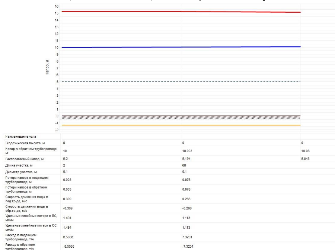
Рисунок 2.71 – Пьезометрический график от источника теплоснабжения (Котельной с. Нагорское) до самого удаленного потребителя
