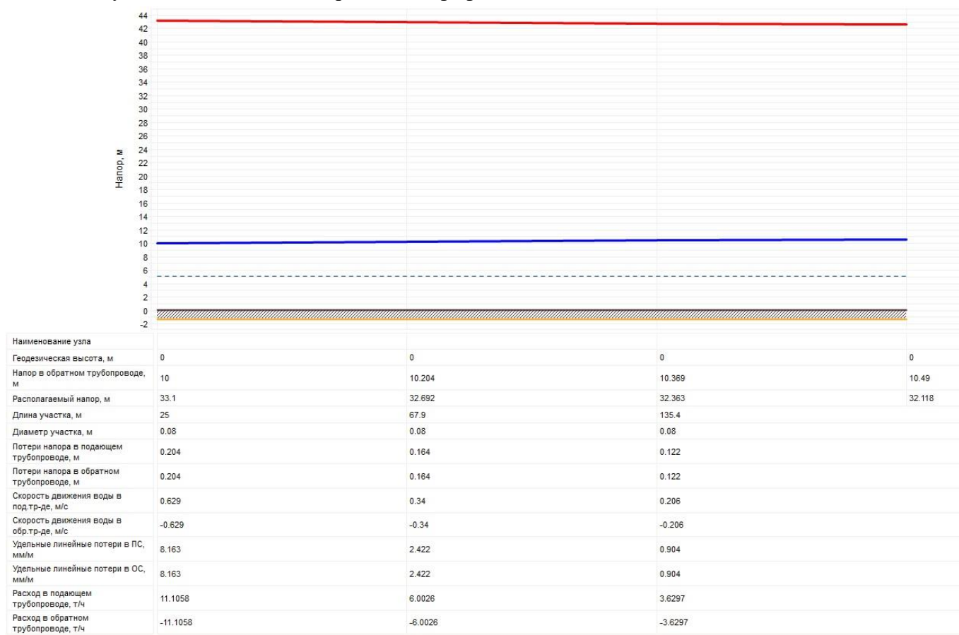
Рисунок 2.24 – Пьезометрический график тепловой сети Котельной №2 с. Глядянское до домов по ул. Карла Маркса
