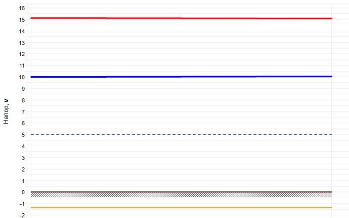
Рисунок 2.20 – Пьезометрический график тепловой сети Котельная с. Ярославское
