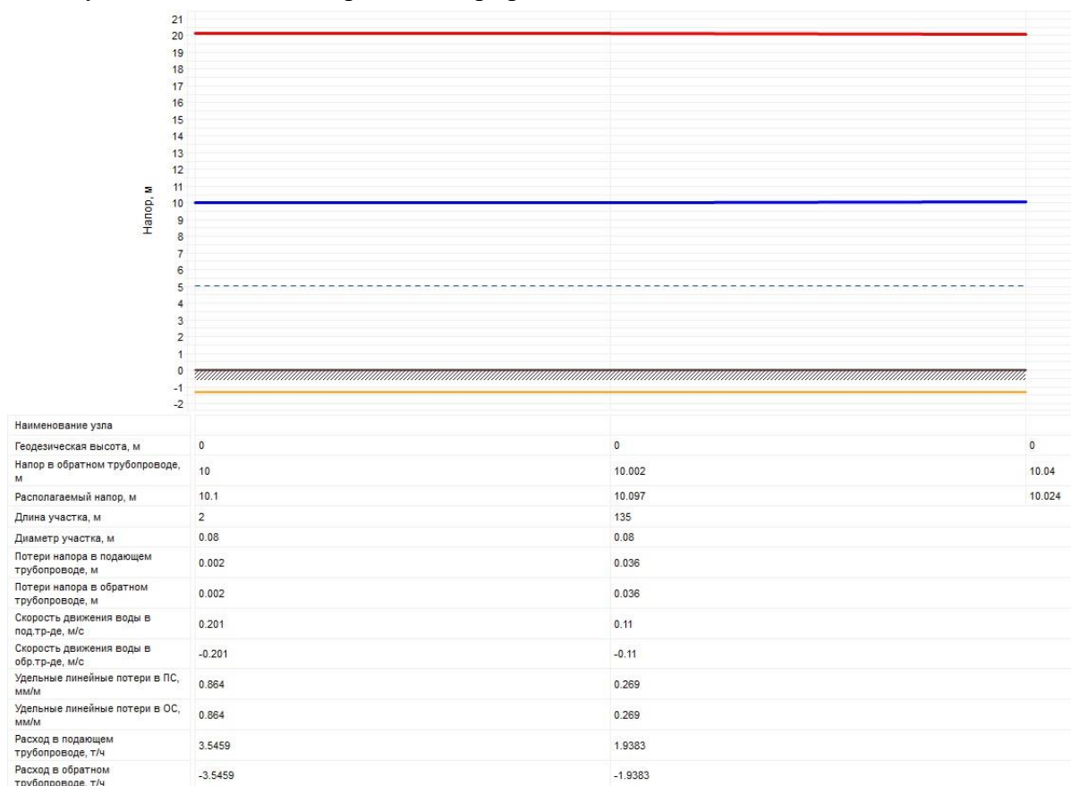
Рисунок 2.34 – Пьезометрический график тепловой сети Котельная с. Плотниково
