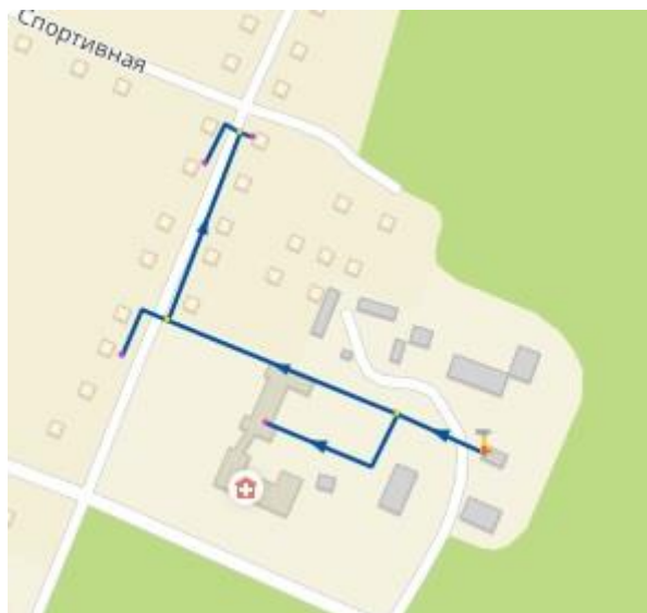
Рисунок 2.47 – Модель системы теплоснабжения Котельной ЦРБ с. Глядянское
