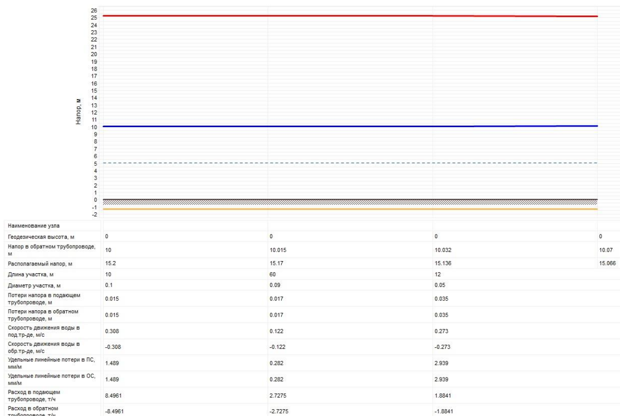
Рисунок 2.82 – Пьезометрический график от Котельной с. Гладковское до самого удаленного потребителя в аварийной ситуации
