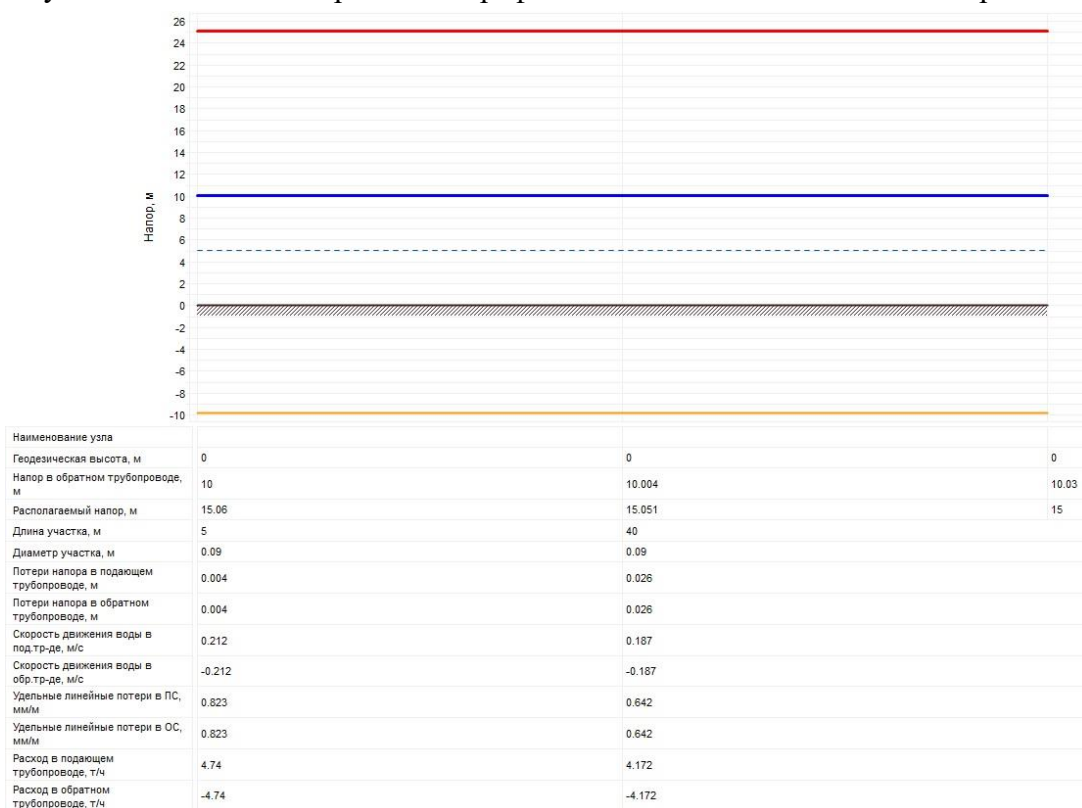
Рисунок 2.32 – Пьезометрический график тепловой сети Котельная с. Межборное
