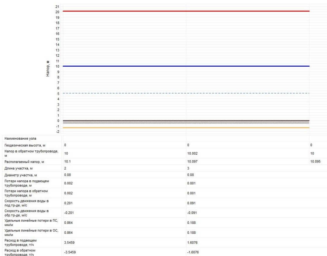
Рисунок 2.68 – Пьезометрический график от источника теплоснабжения (Котельной с. Плотниково) до самого удаленного потребителя
