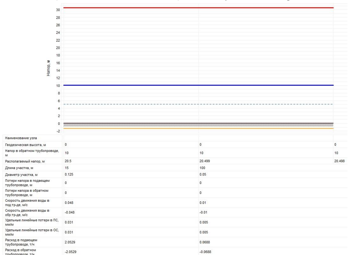
Рисунок 2.65 – Пьезометрический график от источника теплоснабжения (Котельной п. Водный) до самого удаленного потребителя
