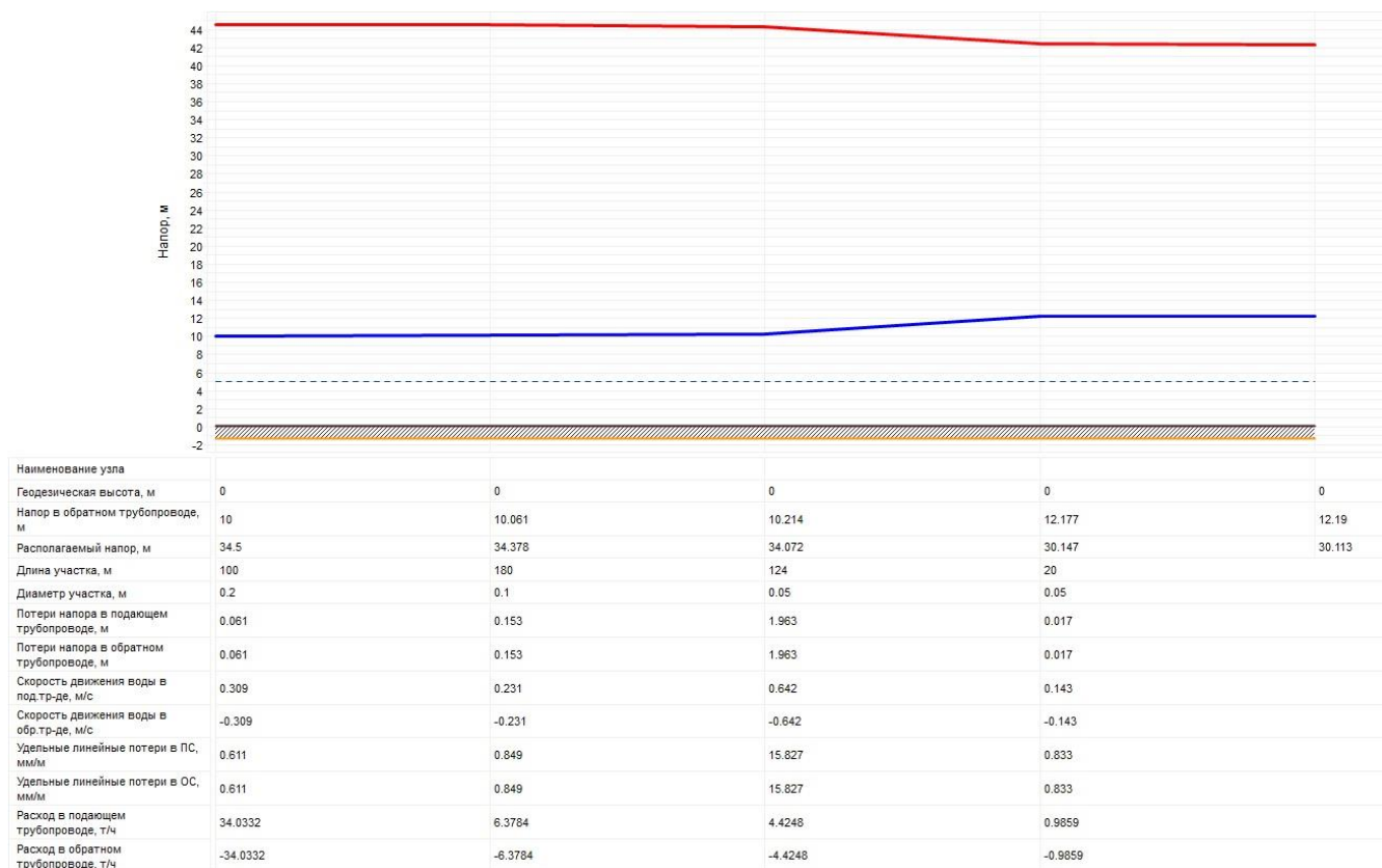
Рисунок 2.77 – Пьезометрический график от Котельной ЦРБ с. Глядянское до самого удаленного потребителя в аварийной ситуации
