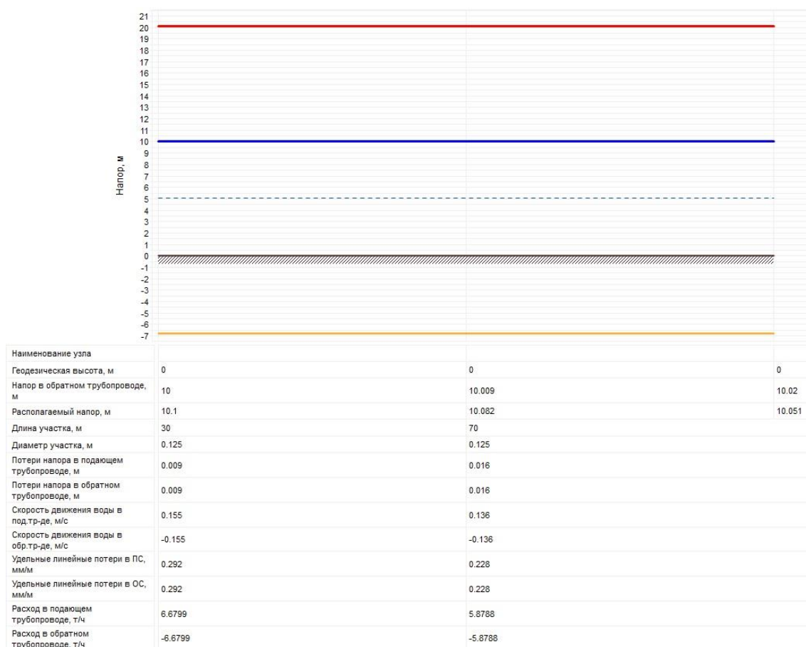
Рисунок 2.85 – Пьезометрический график от Котельной с. Ялым до самого удаленного потребителя в аварийной ситуации
