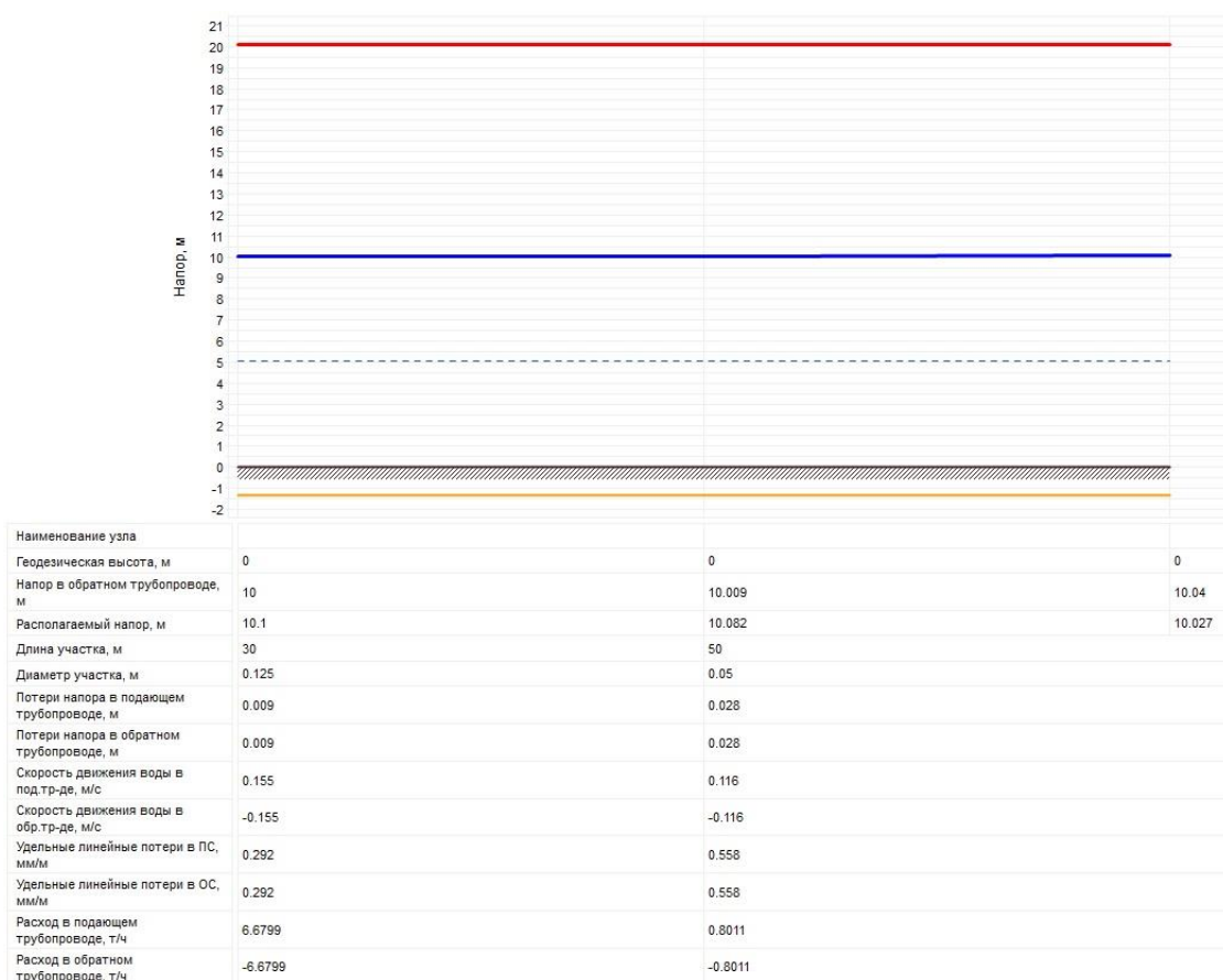
Рисунок 2.70 – Пьезометрический график от источника теплоснабжения (Котельной с. Ялым) до самого удаленного потребителя
