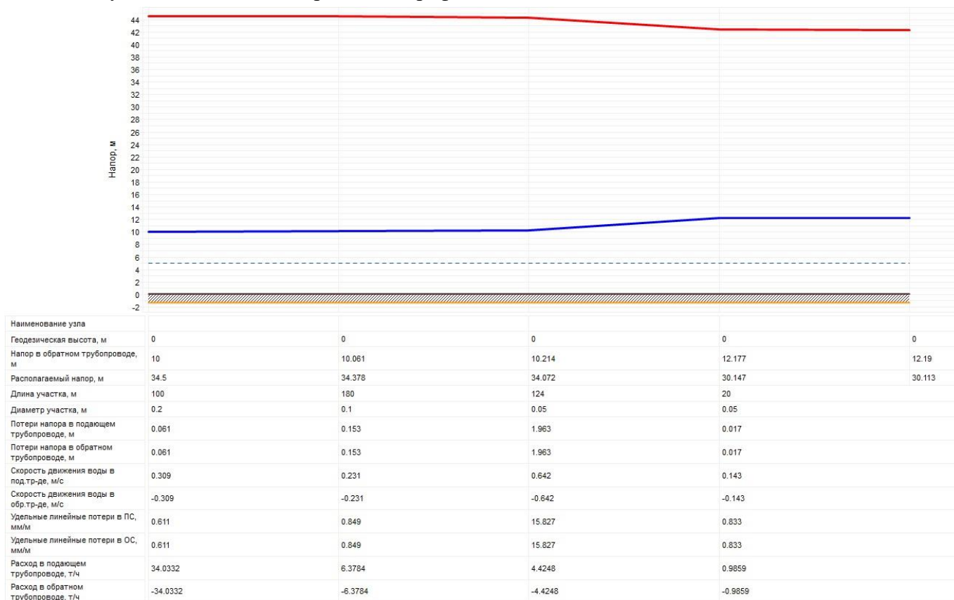
Рисунок 2.28 – Пьезометрический график тепловой сети Котельная ЦРБ с. Глядянское
