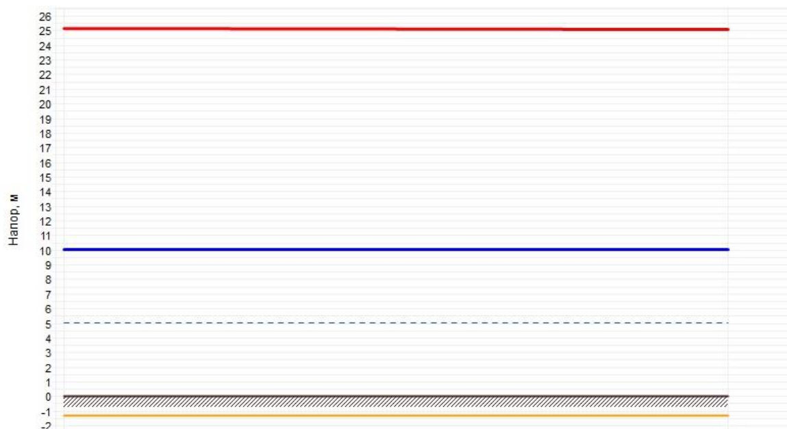
Рисунок 2.12 – Пьезометрический график тепловой сети Котельная д. Верхнеберезово
