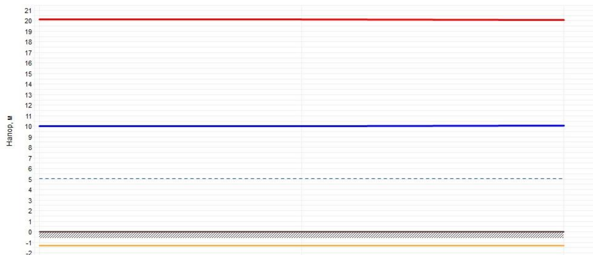
Рисунок 2.16 – Пьезометрический график тепловой сети Котельная с. Плотниково
