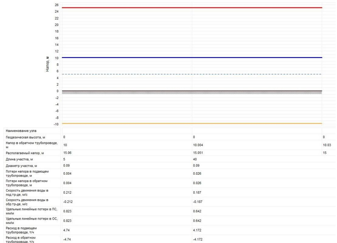
Рисунок 2.32 – Пьезометрический график тепловой сети Котельная с. Межборное
