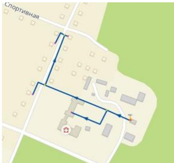
Рисунок 2.47 – Модель системы теплоснабжения Котельной ЦРБ с. Глядянское
