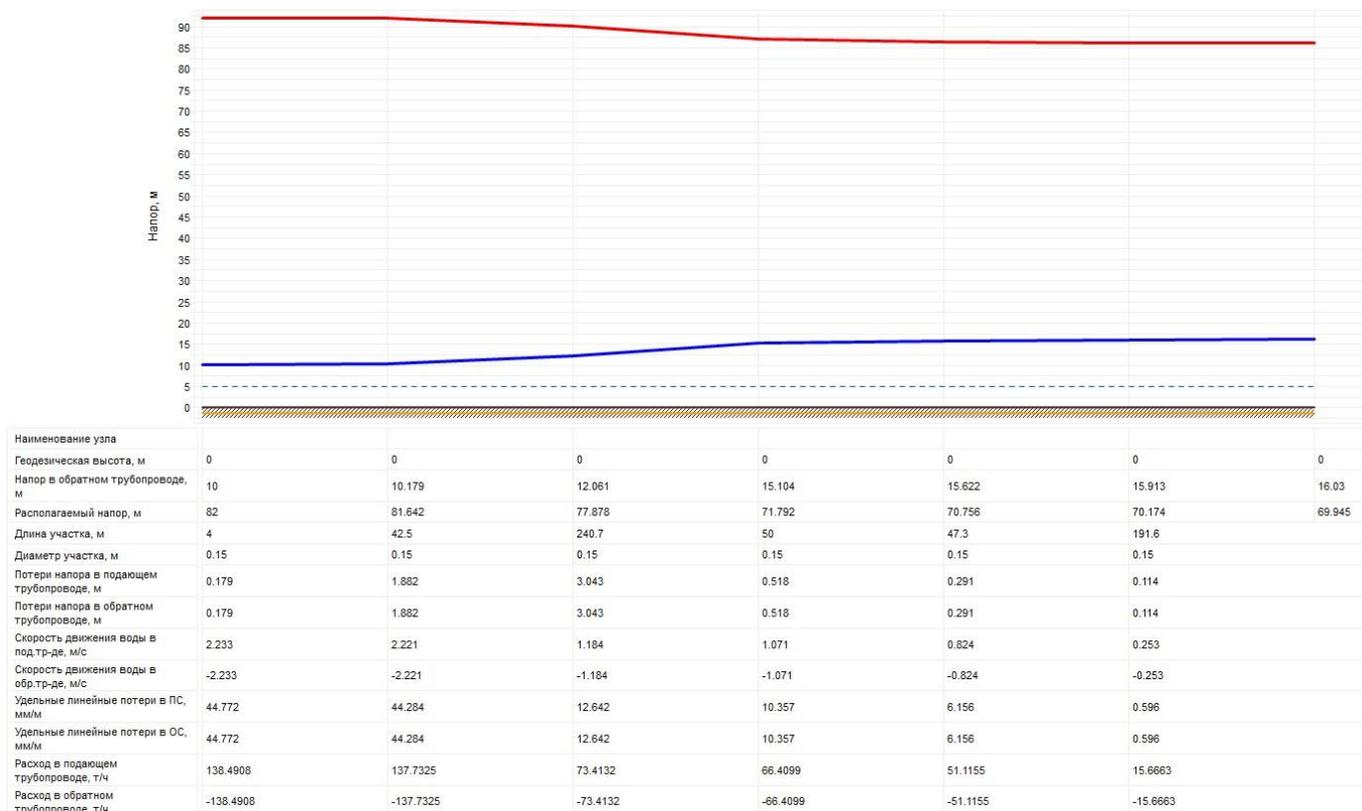
Рисунок 2.23 – Пьезометрический график тепловой сети Котельной №1 с. Глядянское
