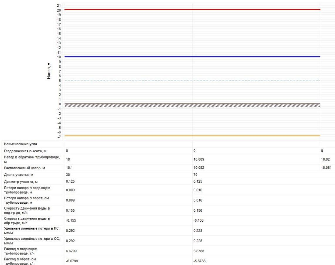
Рисунок 2.85 – Пьезометрический график от Котельной с. Ялым до самого удаленного потребителя в аварийной ситуации
