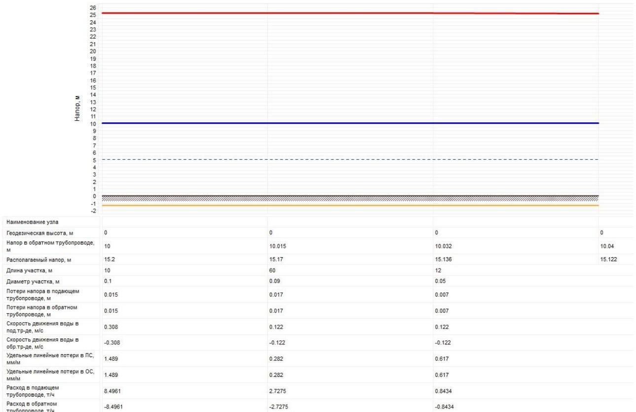
**Рисунок 2.67 – Пьезометрический график от источника теплоснабжения (Котельной с. Гладковское) до самого удаленного потребителя**
