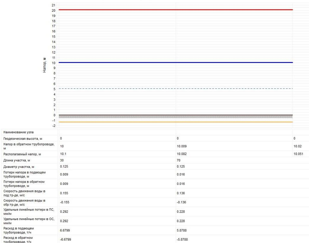
Рисунок 2.36 – Пьезометрический график тепловой сети Котельная с. Ялым
