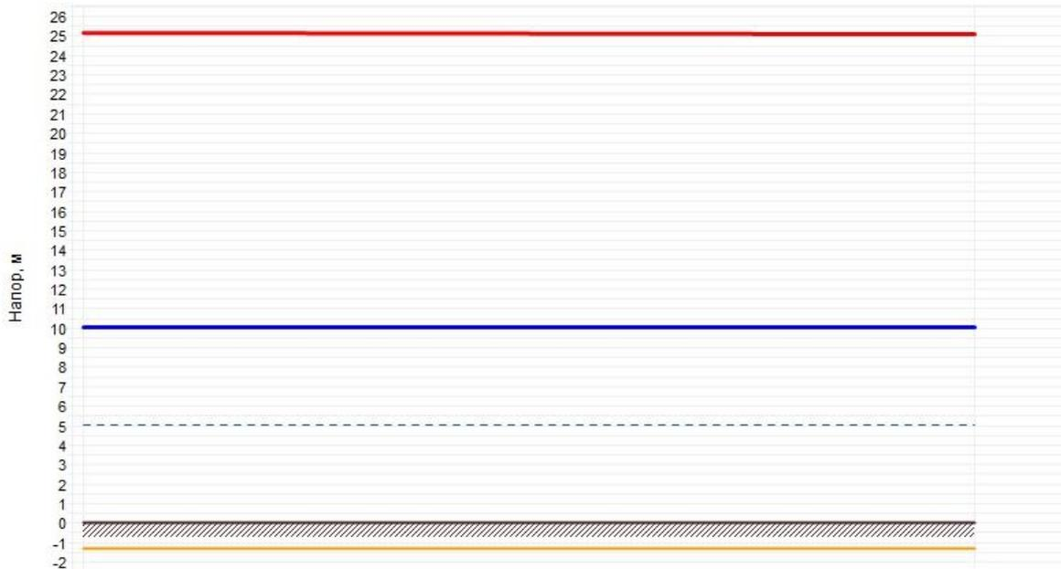
Рисунок 2.12 – Пьезометрический график тепловой сети Котельная д. Верхнеберезово
