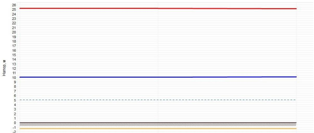
Рисунок 2.15 – Пьезометрический график тепловой сети Котельная с. Gladkovskoye
