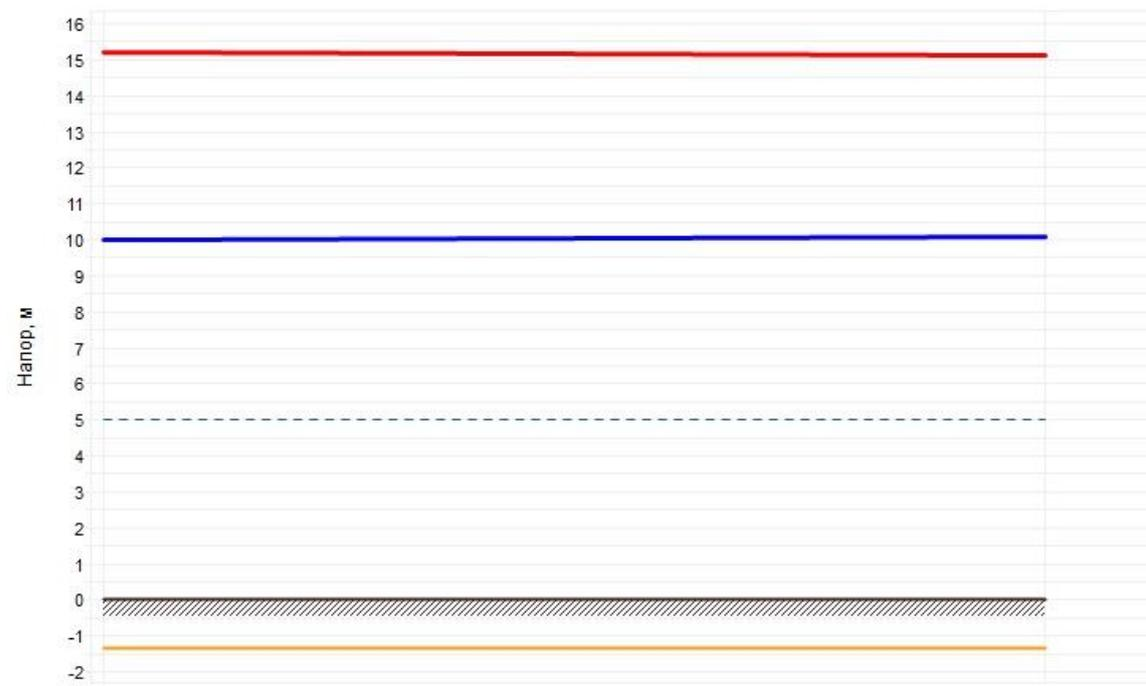
Рисунок 2.21 – Пьезометрический график тепловой сети Котельная с. Чернавское
