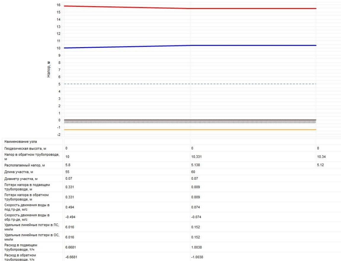
Рисунок 2.35 – Пьезометрический график тепловой сети Котельная с. Раскатиха
